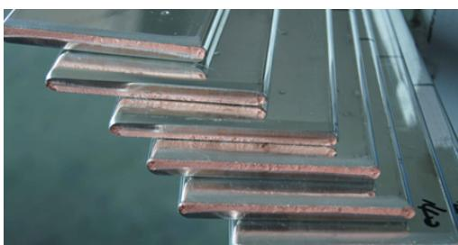
铜排又称铜母线、铜母排或铜汇流排、接地铜排，是由铜材质制作的，截面为矩形或倒角(圆角)矩形的长导体。广泛应用高、低压配电设施的导电之间的连接。如：配电柜、变压器、高低压开关、母线桥架、电子散热器、电器元件等。由于铜的导电性能好，铜排在电气设备，特别是成套配电装置中得到了广泛的应用；一般在配电柜中的 U、V、W 相母排和 PE 母排均采用铜排。对于加工好的铜排，需要按以下标准进行验收：
